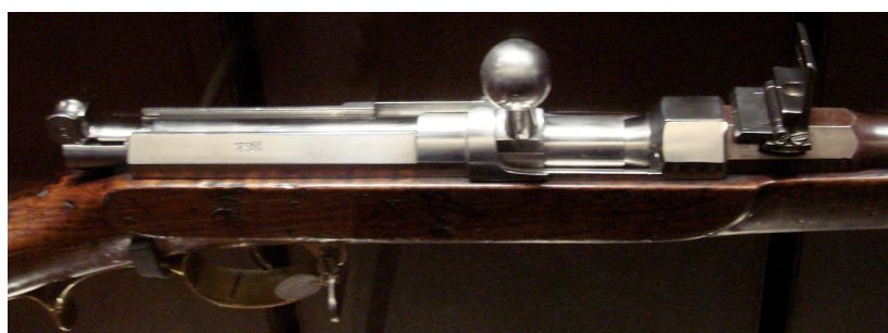
Figura 6 - O mecanismo de municiação do fuzil de “agulha” Drysa modelo 1865 23
