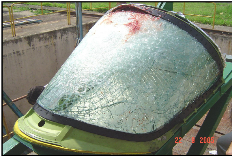
Figura 21 Teste de Resistência a Impactos de Pássaros Foto: Ten.-Cel Diniz
