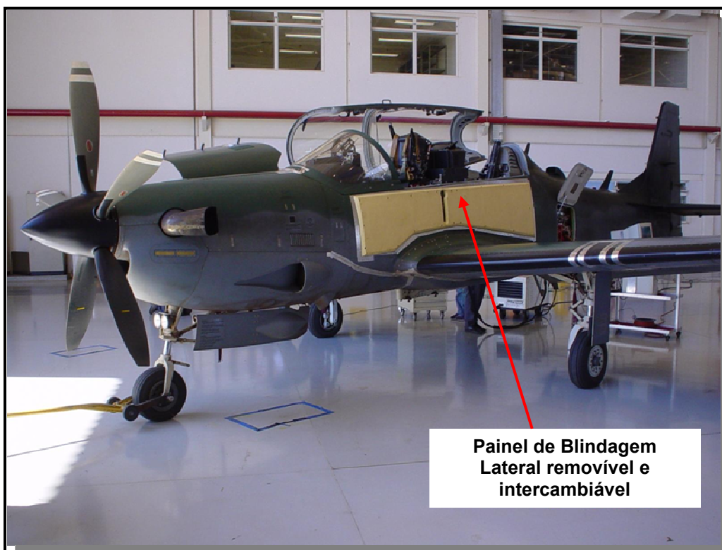
Figura 13 Painel de Blindagem instalado no caça AL-X Foto: Ten.-Cel Diniz
