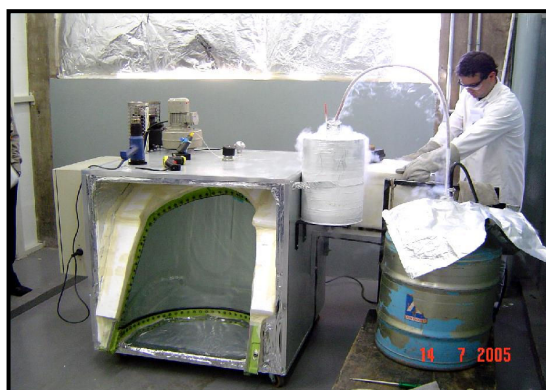
Figura 20 Teste de Resistência ao Choque Térmico Foto: Ten.-Cel Diniz
