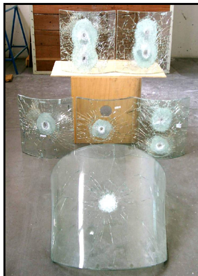
Figura 19 Teste de Resistência Balística (calibre 7, 62mm) Foto: Ten.-Cel Diniz
