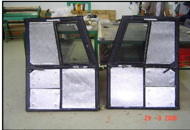
Figura 26 Blindagem das portas
