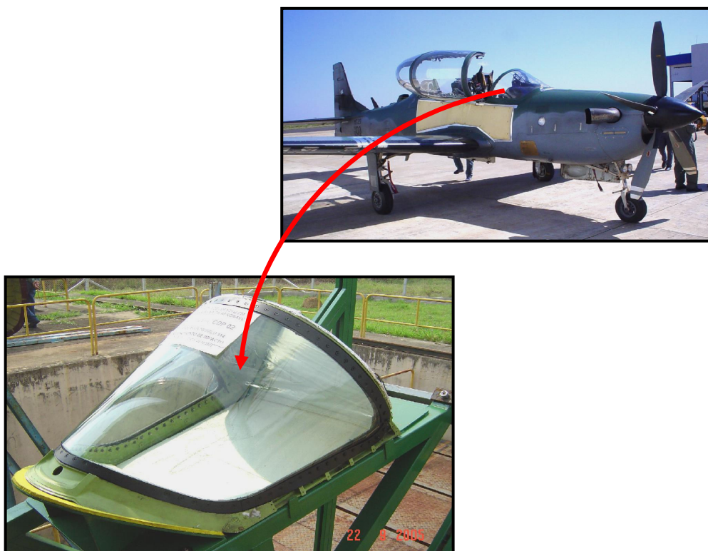
Figura 17 Detalhes do pára-brisa blindado no caça AL-X Foto: Ten.-Cel Diniz
