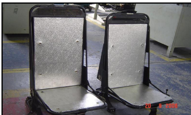
Figura 25 Blindagem do assento e do encosto dos bancos Fonte: Ten.-Cel Diniz
